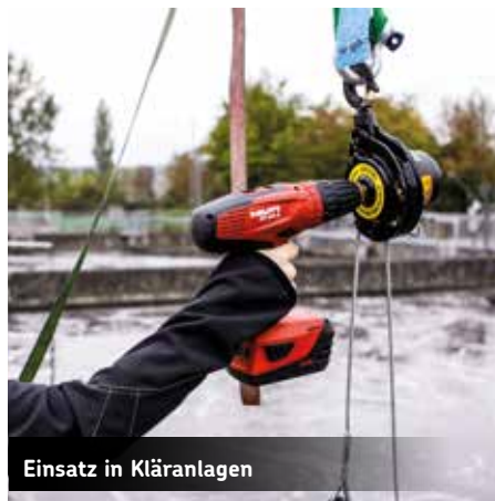
Befestigung am Dreibein durch Adapterplatte mit Anschlagring
