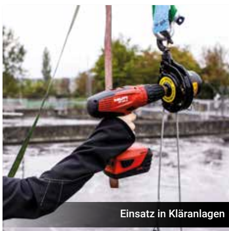
Befestigung am Dreibein durch Adapterplatte mit Anschlagring
