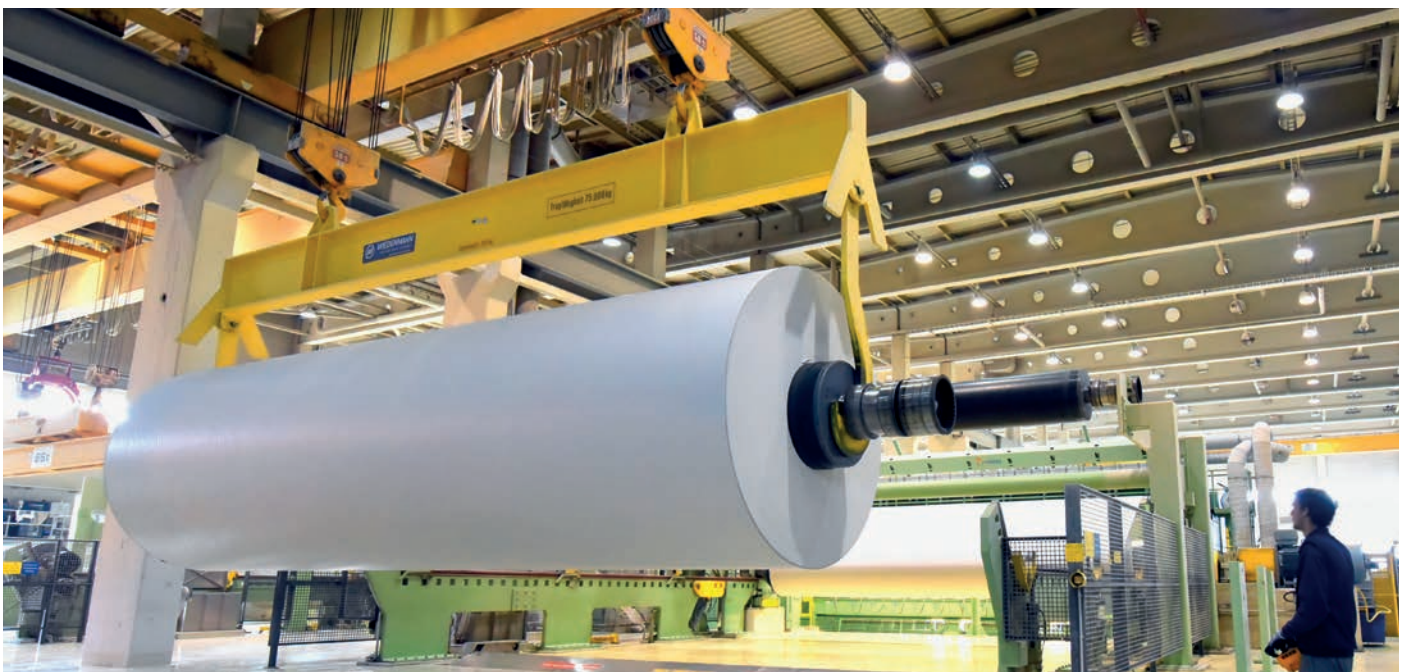
Tambourtraverse mit 75 t Tragfähigkeit in Aktion in einem Papierwerk
