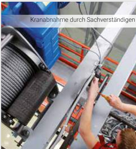
Prüfung, Wartung und Reparatur von Schwenkkränen
