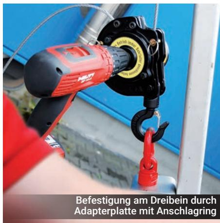
Befestigung am Dreibein durch Adapterplatte mit Anschlagring
