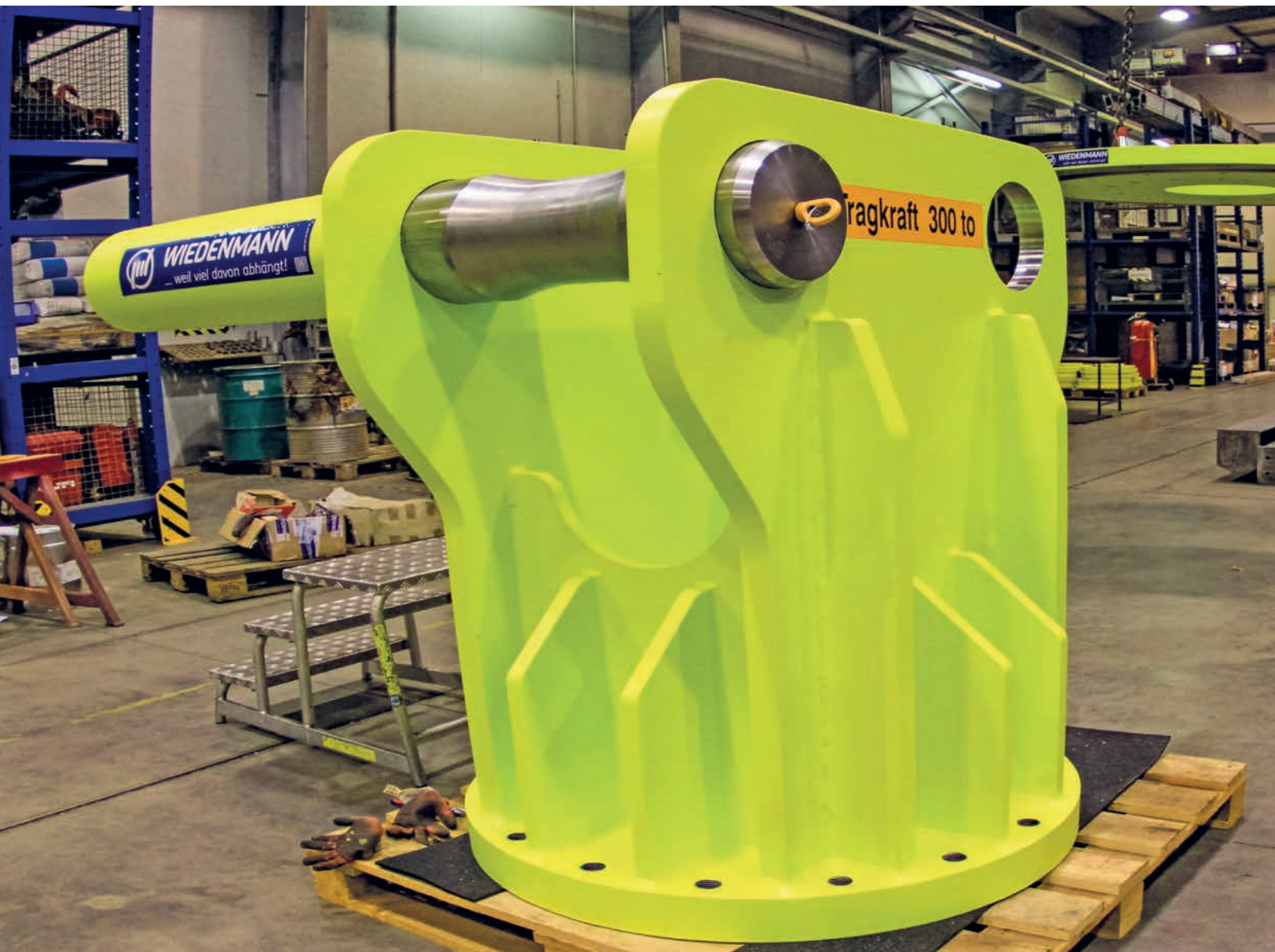
Hebevorrichtung mit 300 t Tragfähigkeit, für die Endmontage eines Wasserturbinen-Rotors
