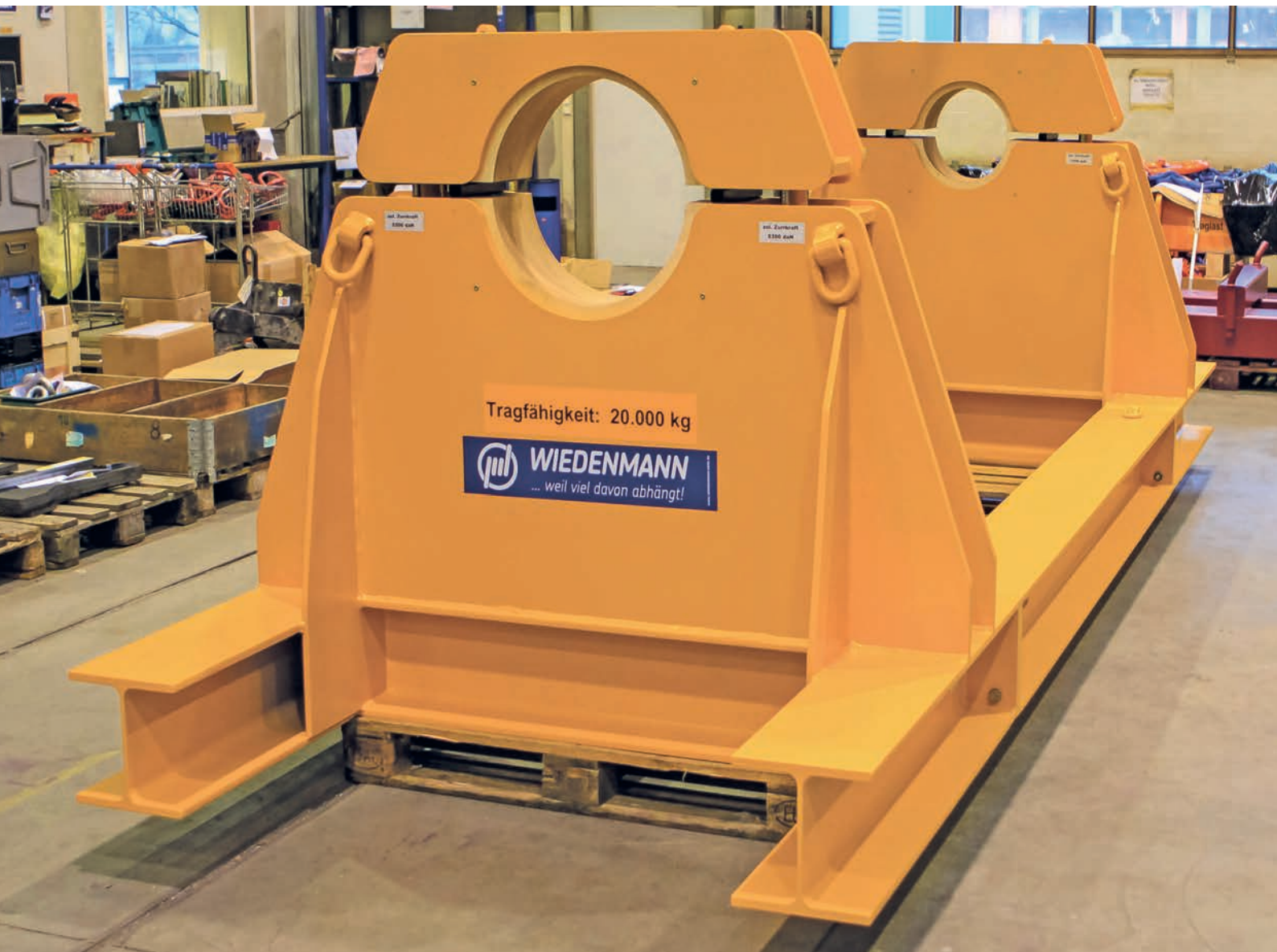
Transportgestell für einen Gasturbinenläufer
