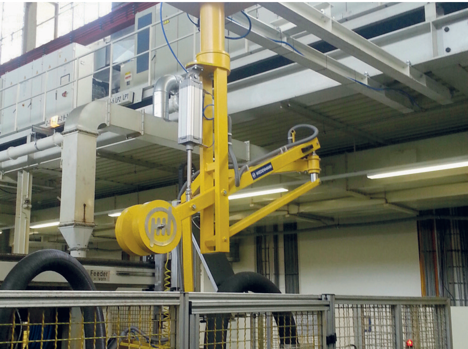
Pneumatischer Dreh-Knickarm zum Wechseln von Induktionsspulen
