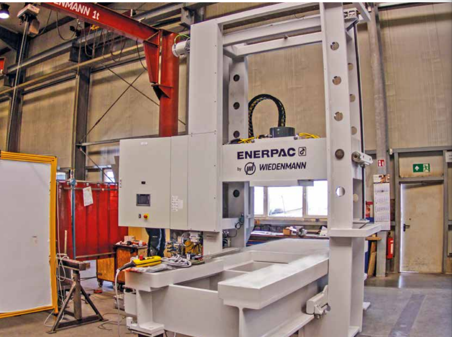
Rollrahmenpressen mit 3.036 kN Druckkraft und elektro-mechanisch einstellbarem Oberjoch
