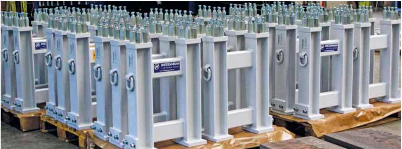
Stützkonstruktionen zum sicheren Abstellen von Zug-Antriebssystemen vor der Endmontage
