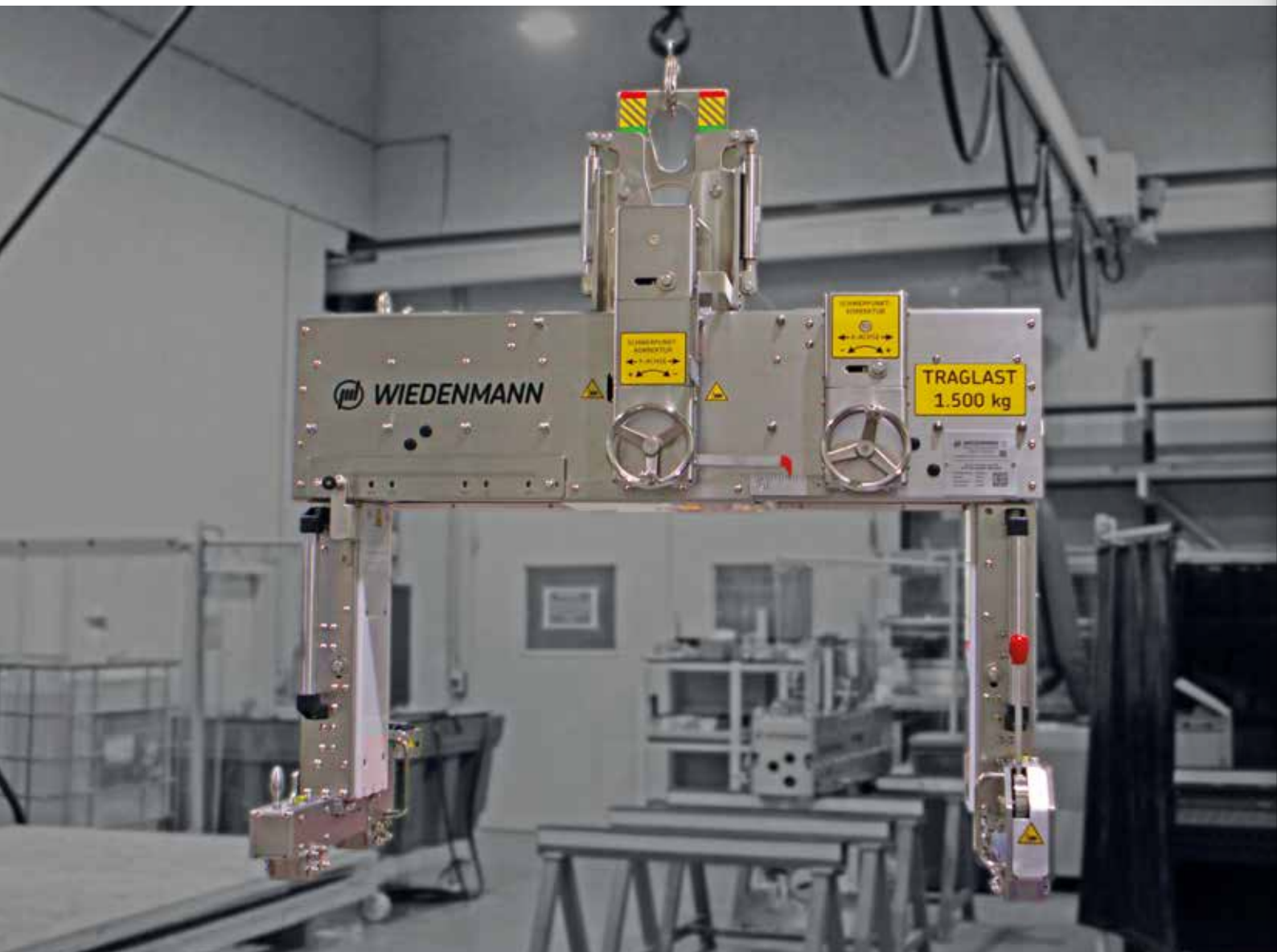
Mechanischer Hebegreifer aus nichtrostenden Edelstahl für Reinraumbetrieb ISO 6
