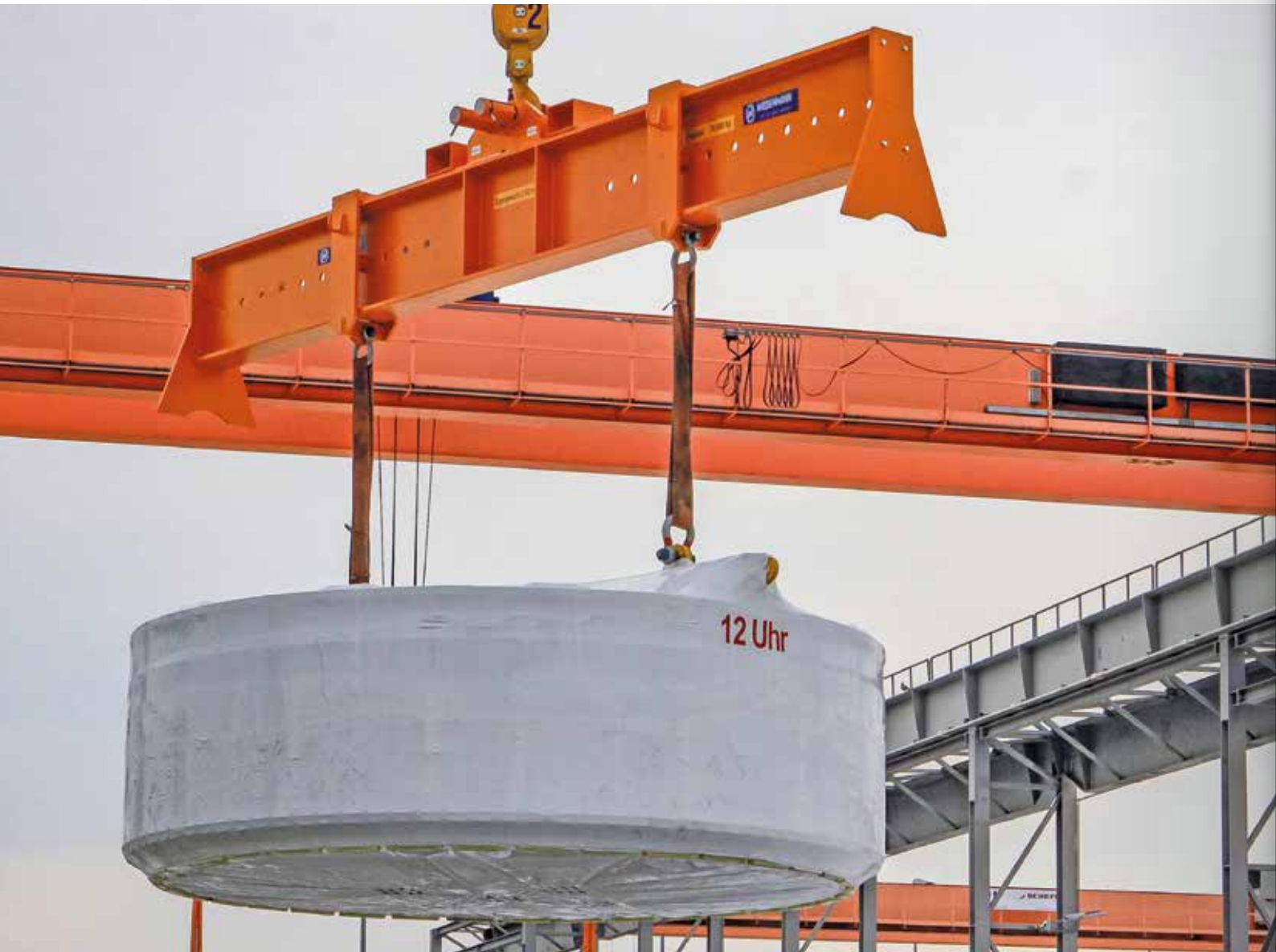
Verstellbare Krantraverse mit 70 t Tragfähigkeit zur Bauteilverladung für Windenergieanlagen
