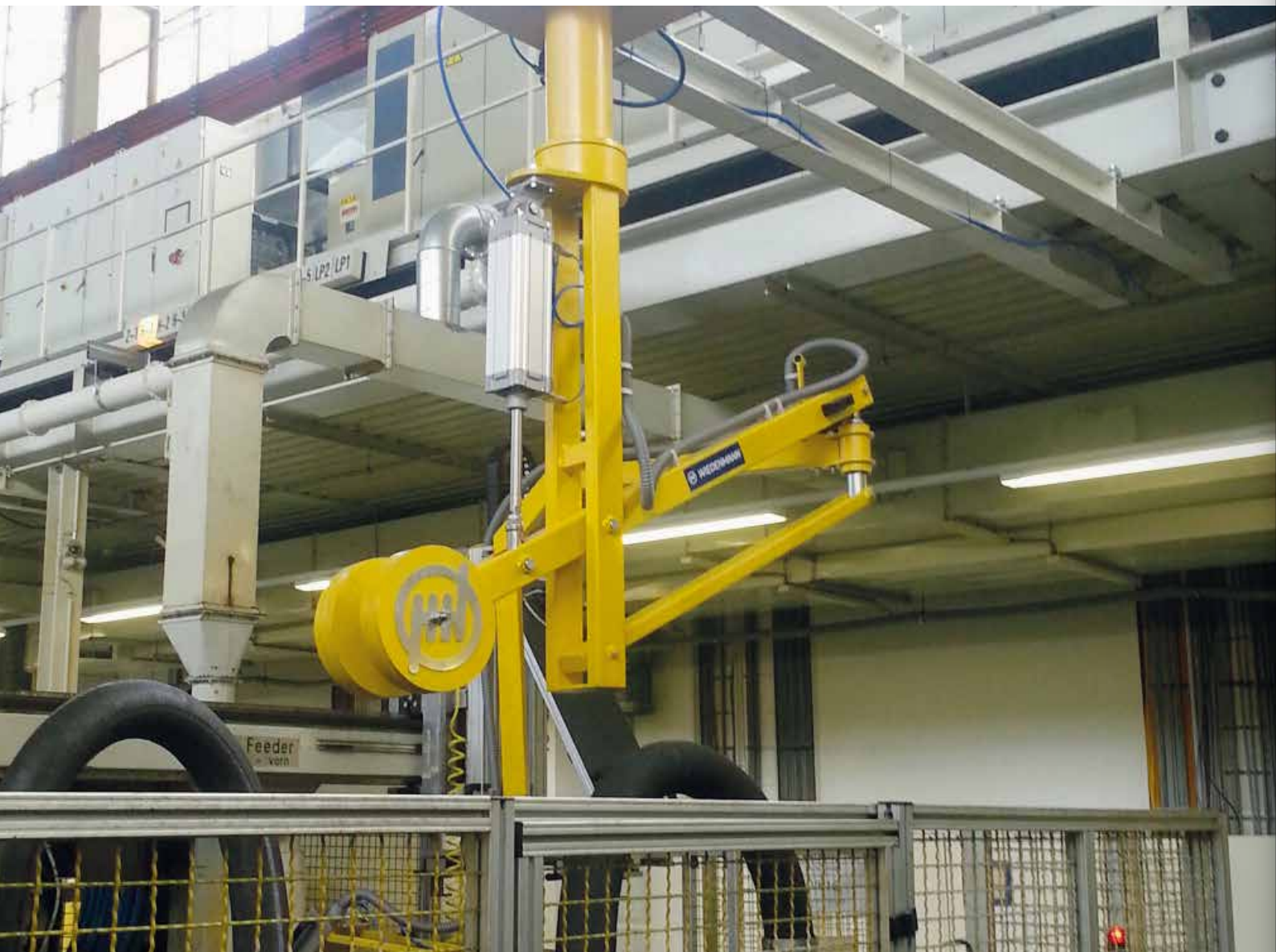
Pneumatischer Dreh-Knickarm zum Wechseln von Induktionsspulen
