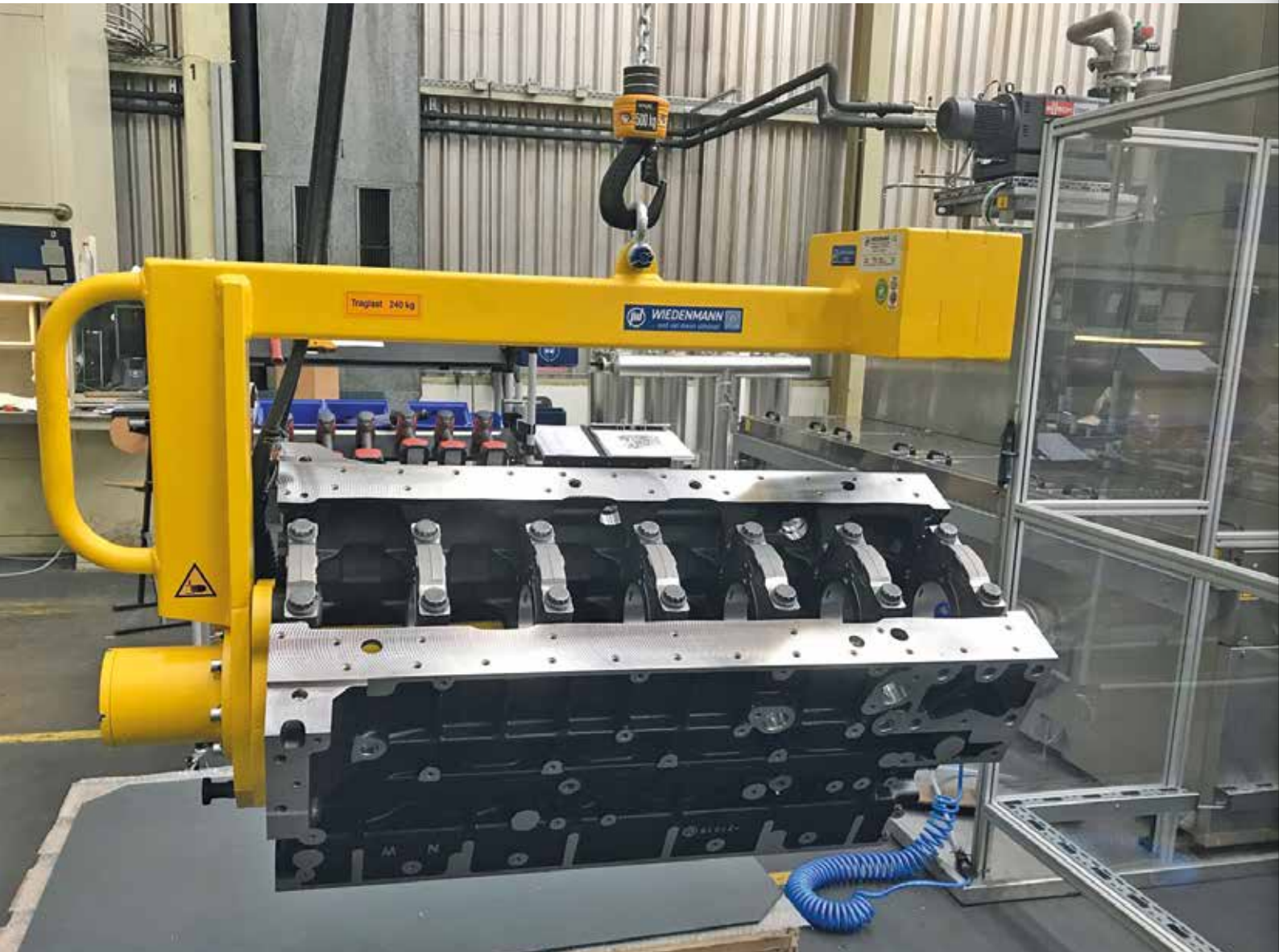
Hebe-Dreh-Greifer für die Handhabung von 240 kg schweren Motor-Kurbelgehäuse
