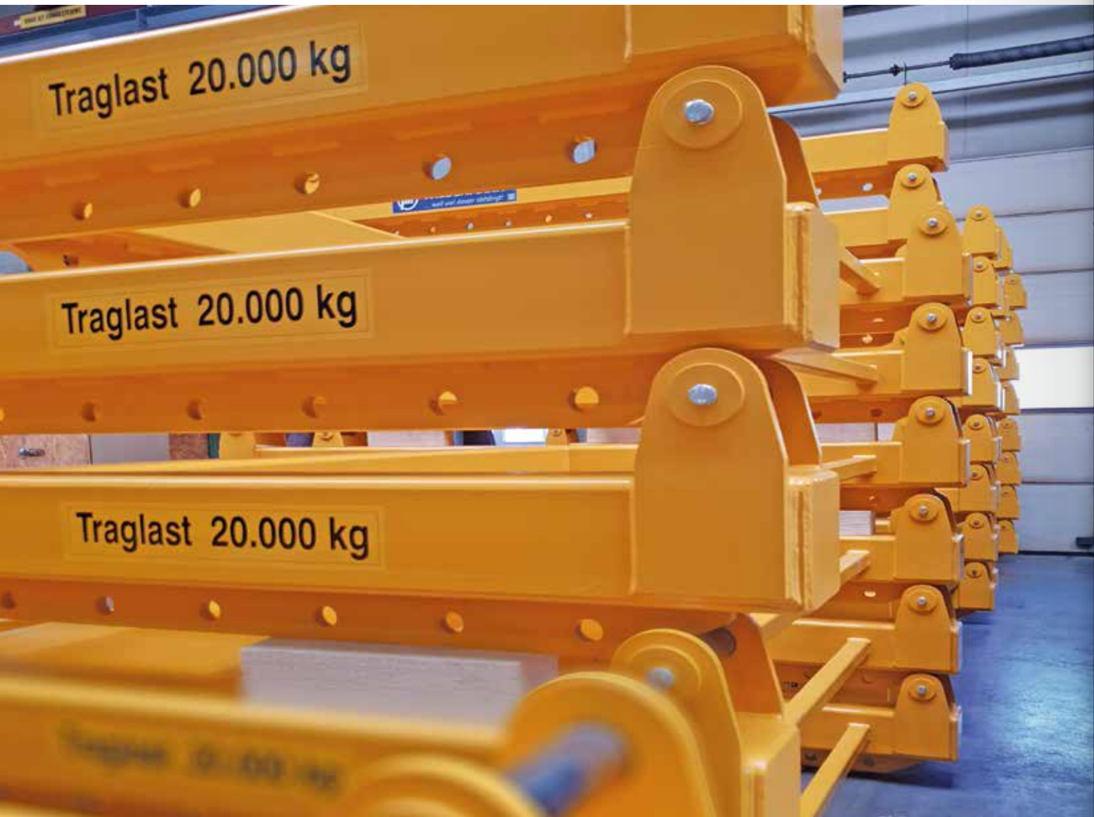
Kleinserie Lastaufnahmemittel zum Integration in eine kundenseitige Förderanlage in der Baumaschinenindustrie
