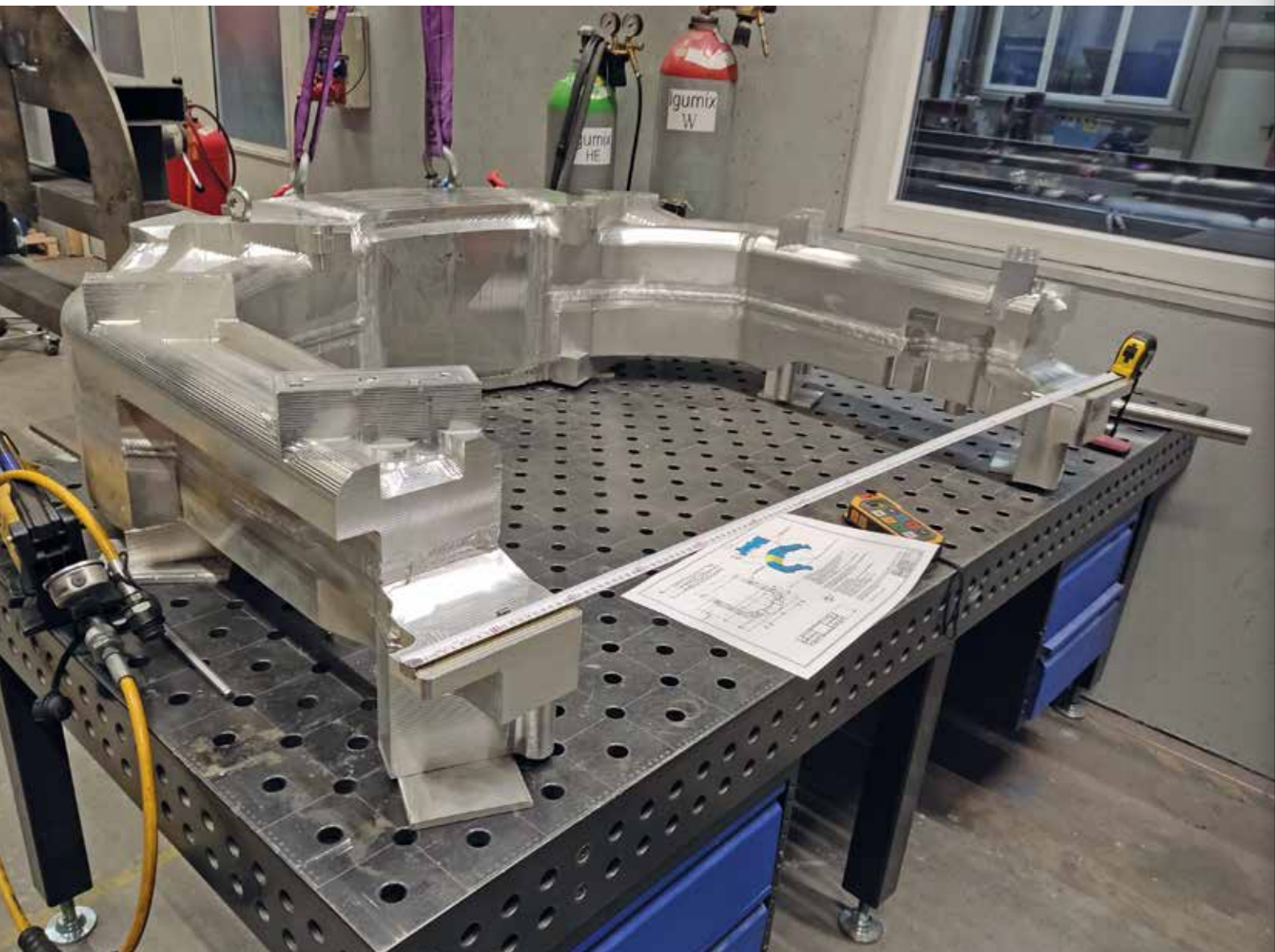
Schweißkonstruktion „Roboterarm“ aus einer AlMg(Mn) - Legierung
