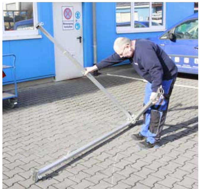
Abb. 59: Den Dreibaum bis zum nächsten 2. Fuß drehen.
