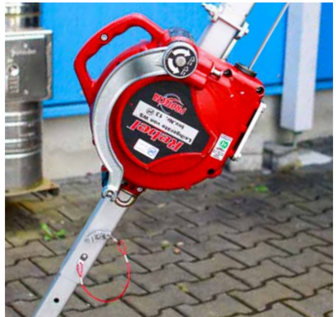
Abb. 43 + 44: Etwas Seil aus dem HSG abspulen um den Karabiner später bequem am Auffanggurt befestigen zu können.
