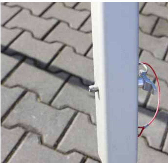
Abb. 54 + 55: Dann den Sicherungsstift des 1. Fußes entriegeln...
