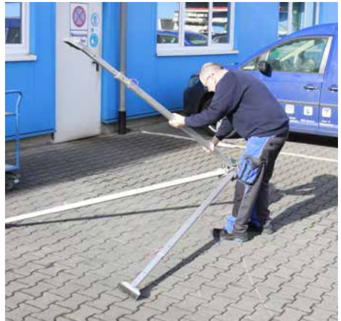
Abb. 51: Zum ABBAU das HSG in umgekehrter Reihenfolge zurückbauen und dann zuerst die Sicherungskette wieder entfernen.
