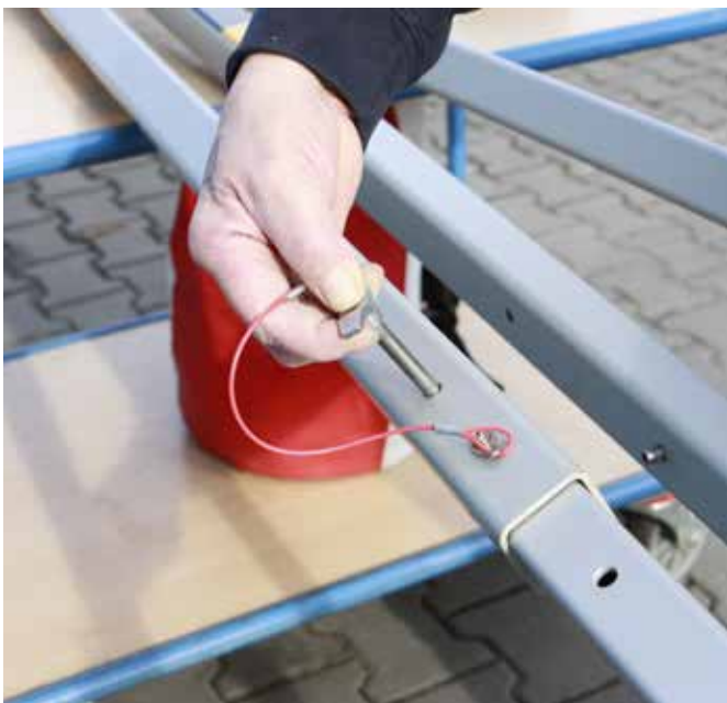
Abb. 9: Sicherung mit den Steckbolzen nicht vergessen!
