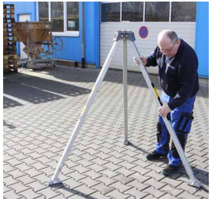
Abb. 64 + 65: ...so dass der Dreibaum nun wieder stabil auf allen drei (verkürzten) Füßen steht.
