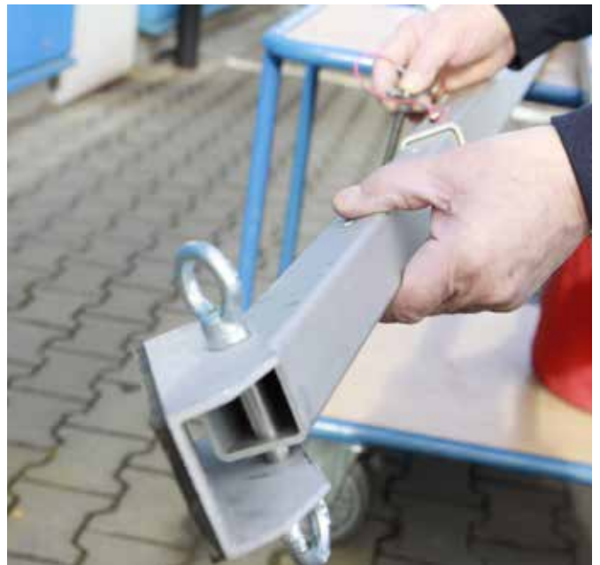
Abb. 7 + 8: Und das Ganze auch beim 3. Fuß wiederholen (hier zu sehen: Ausziehen der Fuß-Verlängerung).
