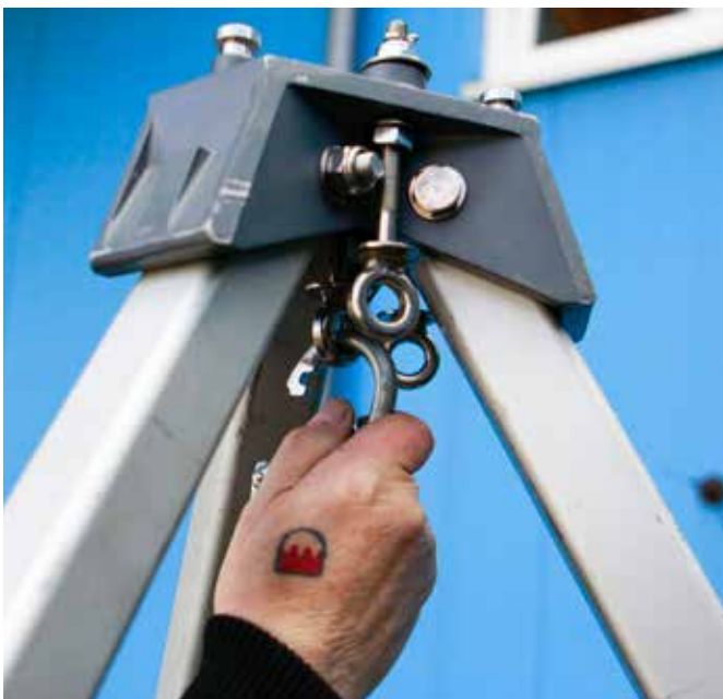
Abb. 33 + 34: Hierzu die mittig angebrachte Ringöse zur Anbringung verwenden und den Karabiner fest verschließen.
