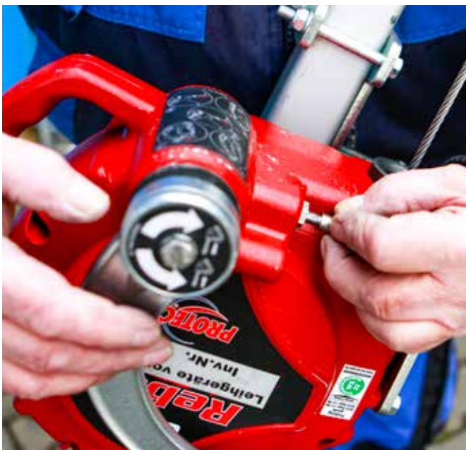
Abb. 47 + 48: Den eingerasteten Sicherungsknopf herausziehen um die Seilwindenfunktion zu aktivieren. Das Gerät ist nun Einsatzbereit.
