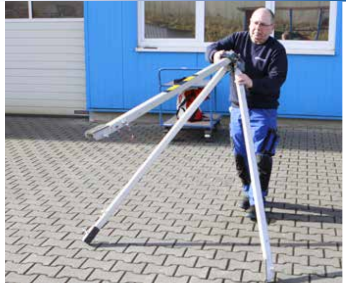
Abb. 63: Anschließend den Dreibaum wieder aufstellen...
