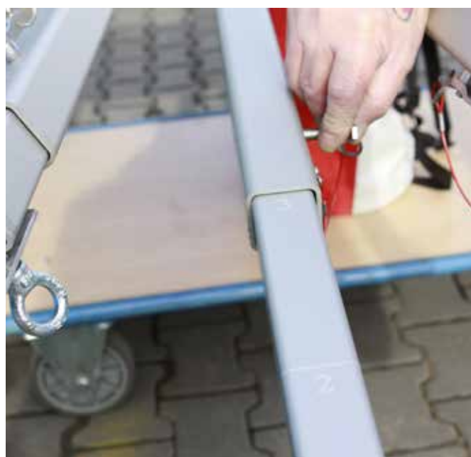
Abb. 4: Dreibaum-Fuß wieder mit dem Steckbolzen sichern.
