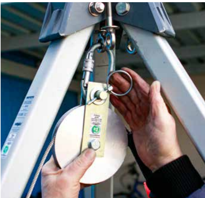
Abb. 41 + 42: Den Klapstecker durch die Bohrung im Bolzen stecken und durch Umklappen des federgelagerten Rings sichern.
