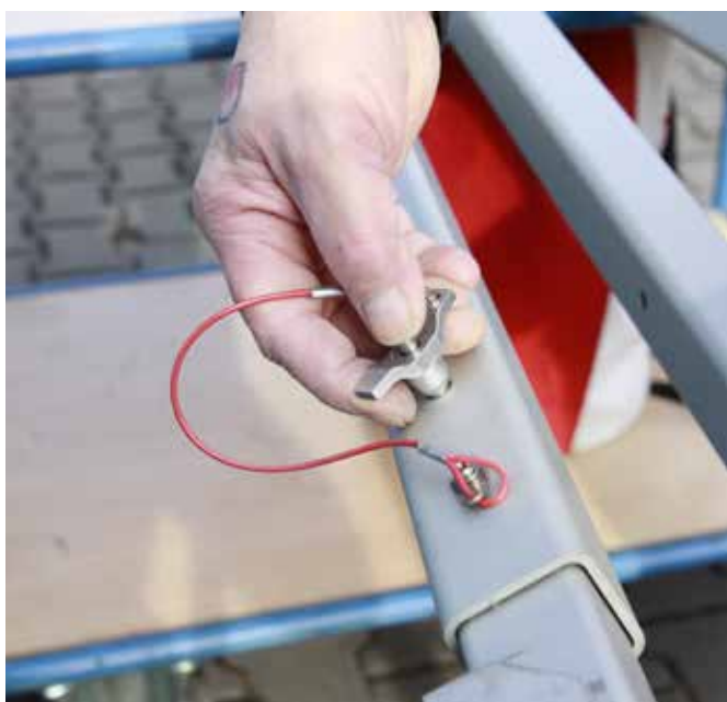
Abb. 5 + 6: Das Prozedere auch beim zweiten Fuß wiederholen (hier zu sehen: Steckbolzen entnehmen).
