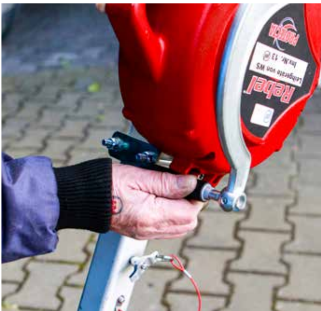
Abb. 45 + 46: Die eingeklappte Kurbel nach außen öffnen (siehe Abb.).
