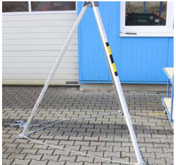
Abb. 23 + 24: Anfangsstück der Sicherungskette mittels mitgelieferten Karabiner an der durchgezogenen Sicherungskette befestigen.
