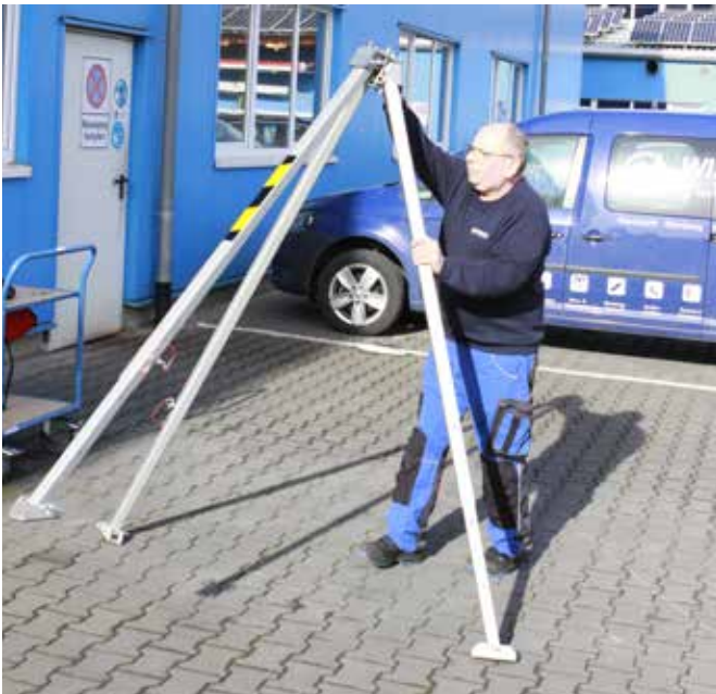
Abb. 52 + 53: Zum Einfahren der Füße am besten den Dreibaum auf die Seite umlegen.
