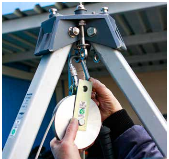
Abb. 35 + 36: Etwas Seil vom HSG abrollen (ca. 1,5 - 2 m) und das Seil um die Seilrolle führen. Dann die Seilrolle mittels...
