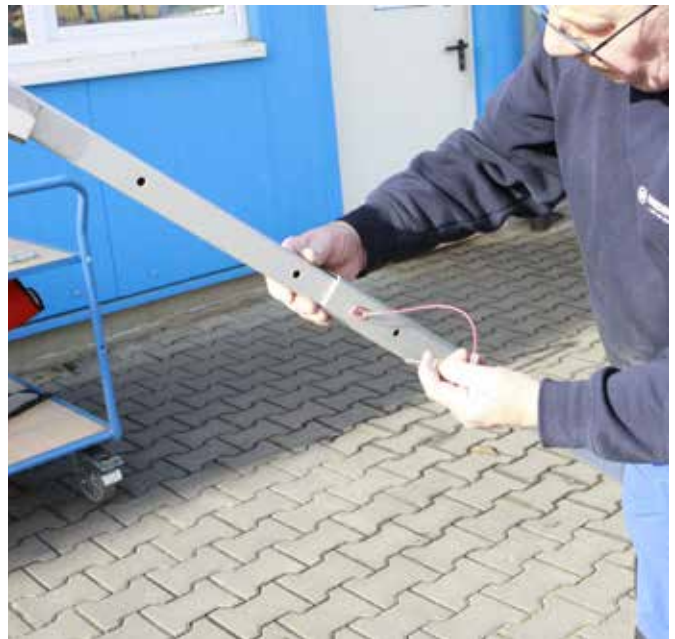
Abb. 56 + 57: Durch Drücken der Entriegelung den Sicherungsstift herausnehmen und den Fuß wieder einfahren.
