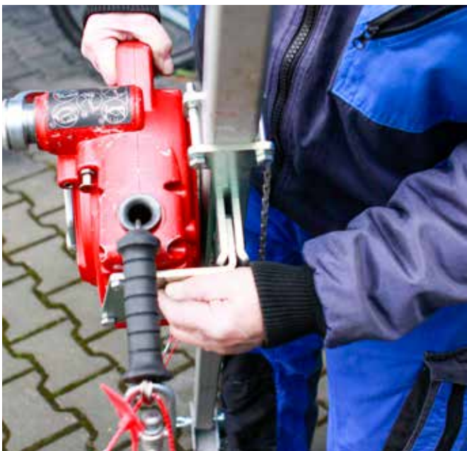
Abb. 29 + 30: ...und mit dem am Adapter angebrachten selbstsichernden Steckbolzen mit Axialsicherung fixieren.
