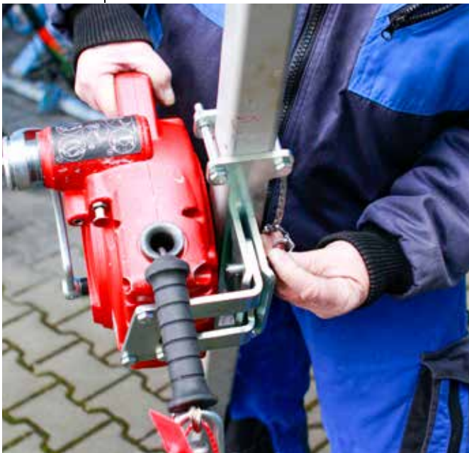
Abb. 31 + 32: Darauf achten, dass der Steckbolzen korrekt sitzt. Dann den Karabinerhaken am Dreibaum anbringen.
