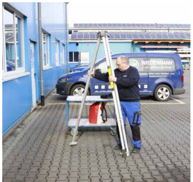
Abb. 12: Das Dreibein aufstellen (Füße auseinanderziehen).
