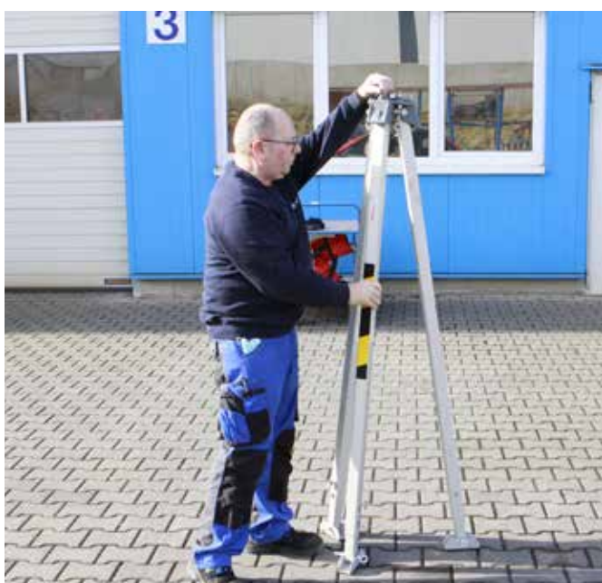
Abb. 70 + 71: Auch dieses Prozedere für jeden einzelnen Fuß wiederholen, bis der Dreibaum...
