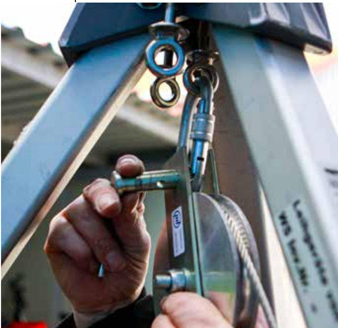
Abb. 37 + 38: ...dem mitgelieferten Steckbolzen wie abgebildet am Karabiner anbringen.
