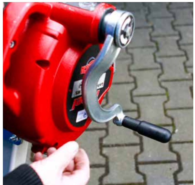
Abb. 43 + 44: Etwas Seil aus dem HSG abspulen um den Karabiner später bequem am Auffanggurt befestigen zu können.
