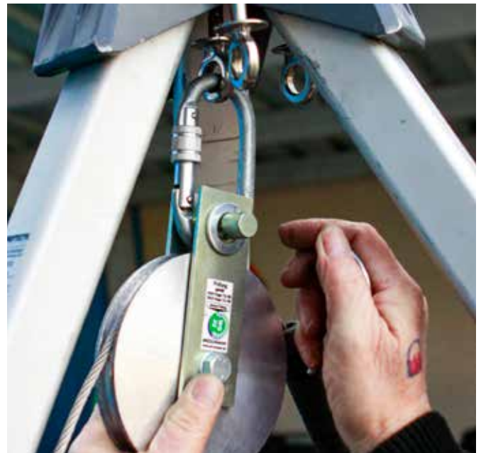
Abb. 39 + 40: Den Bolzen bis zum Anschlag durch die beiden Bohrungen an der Seilrolle stecken und die Beilagscheibe auflegen.
