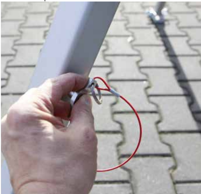
Abb. 56 + 57: Durch Drücken der Entriegelung den Sicherungsstift herausnehmen und den Fuß wieder einfahren.
