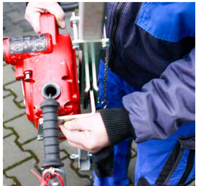
Abb. 27 + 28: Das HSG in den bereits vorinstallierten Befestigungsadapter (wie dargestellt) einführen...
