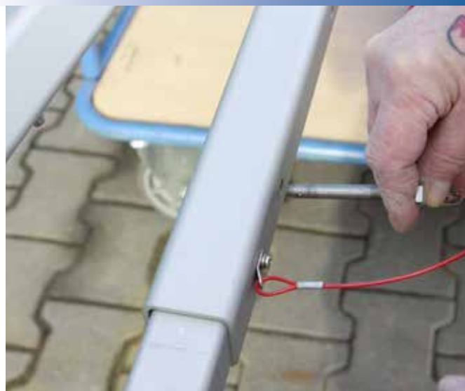
Abb. 1 + 2: START: Steckbolzen zur Verlängerung der Dreibaum-Füße durch Drücken entriegeln und herausziehen.
