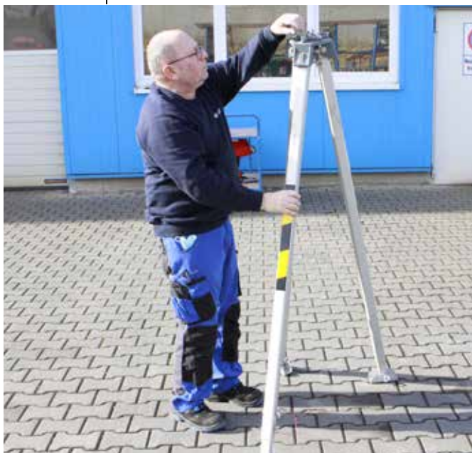
Abb. 68 + 69: ...eingeklappt werden. Bitte darauf achten, dass die Verriegelungsbolzen auch richtig zum Entriegeln herausgezogen werden.
