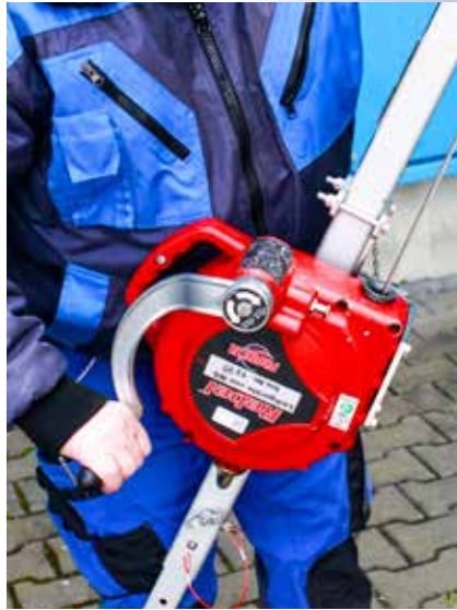
Abb. 51: Zum ABBAU das HSG in umgekehrter Reihenfolge zurückbauen und dann zuerst die Sicherungskette wieder entfernen.
