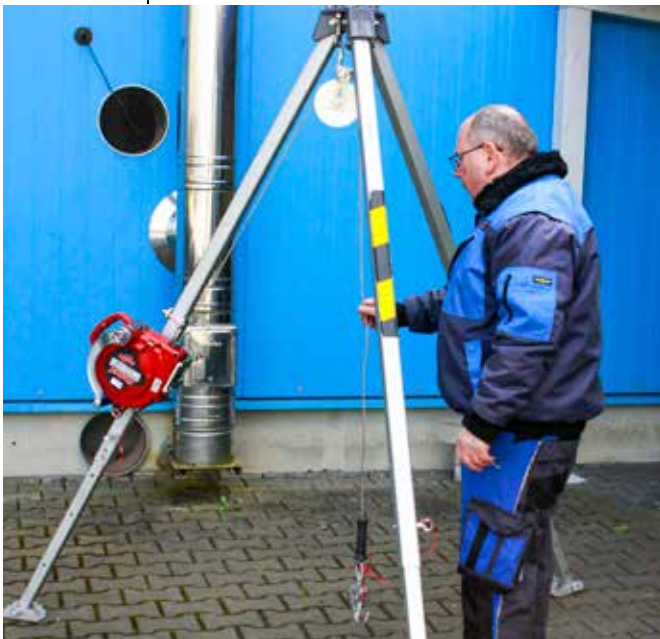
Abb. 43 + 44: Etwas Seil aus dem HSG abspulen um den Karabiner später bequem am Auffanggurt befestigen zu können.
