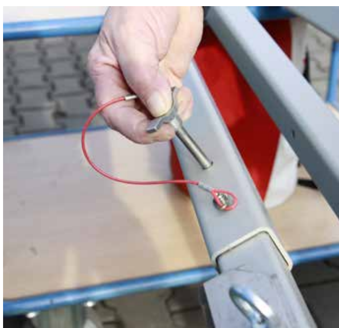
Abb. 5 + 6: Das Prozedere auch beim zweiten Fuß wiederholen (hier zu sehen: Steckbolzen entnehmen).
