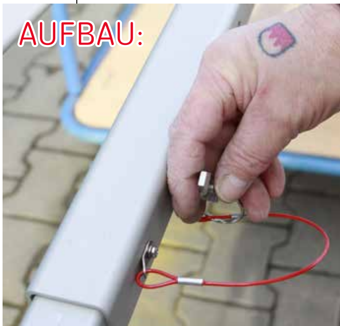
Abb. 1 + 2: START: Steckbolzen zur Verlängerung der Dreibaum-Füße durch Drücken entriegeln und herausziehen.
