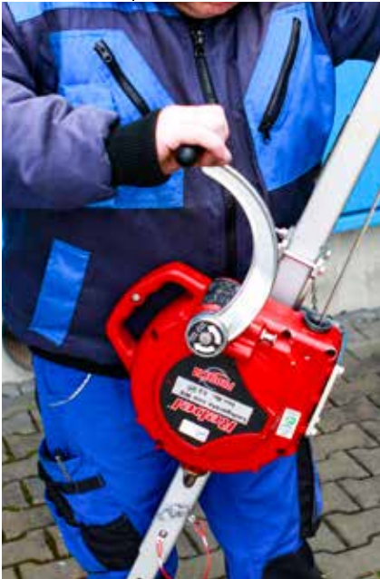
Abb. 49 + 50 : Zum Heben und Senken die Kurbel bedienen!
