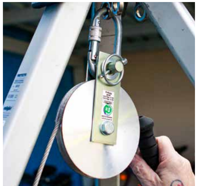
Abb. 41 + 42: Den Klapstecker durch die Bohrung im Bolzen stecken und durch Umklappen des federgelagerten Rings sichern.
