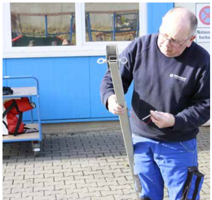
Abb. 60 + 61: Auch beim 2. Fuß den Sicherungsstift entnehmen, Fußverlängerung einfahren und Sicherungsstift wieder einsetzen.
