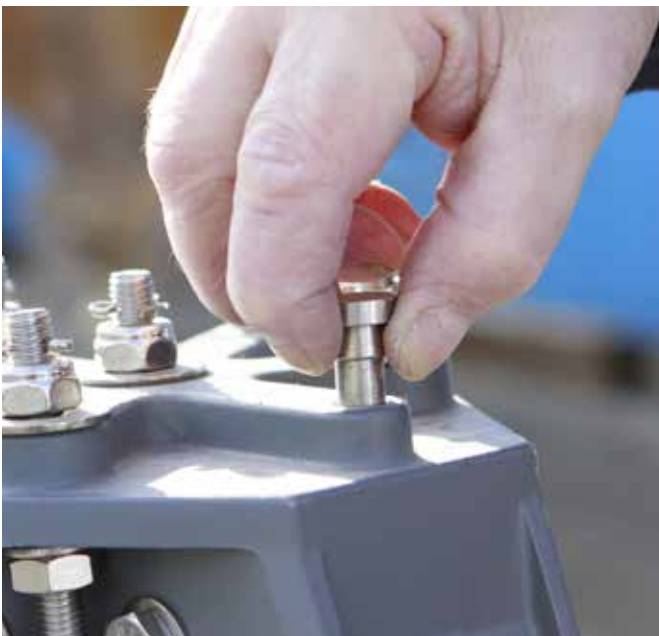
Abb. 66 + 67: Durch herausziehen der Verriegelungs-Bolzens auf der Oberseite des Dreibaums können die Füße - einer nach dem anderen...
