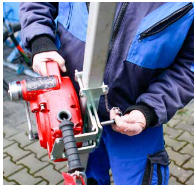
Abb. 29 + 30: ...und mit dem am Adapter angebrachten selbstsichernden Steckbolzen mit Axialsicherung fixieren.
