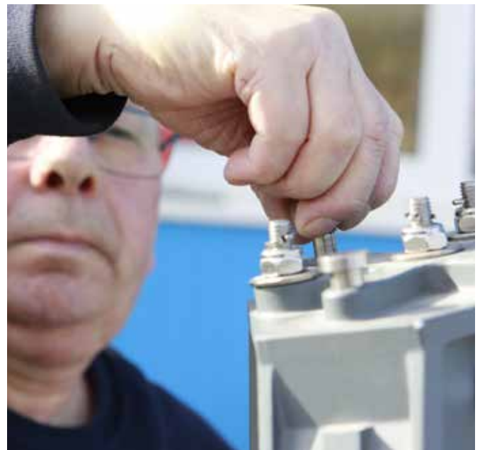
Abb. 66 + 67: Durch herausziehen der Verriegelungs-Bolzens auf der Oberseite des Dreibaums können die Füße - einer nach dem anderen...
