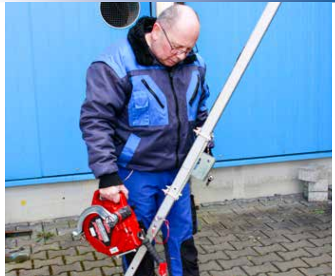
Abb. 25 + 26: Das Zubehör (siehe oben) sowie das Höhensicherungsgerät (HSG) Protecta Rebel bereit legen.
