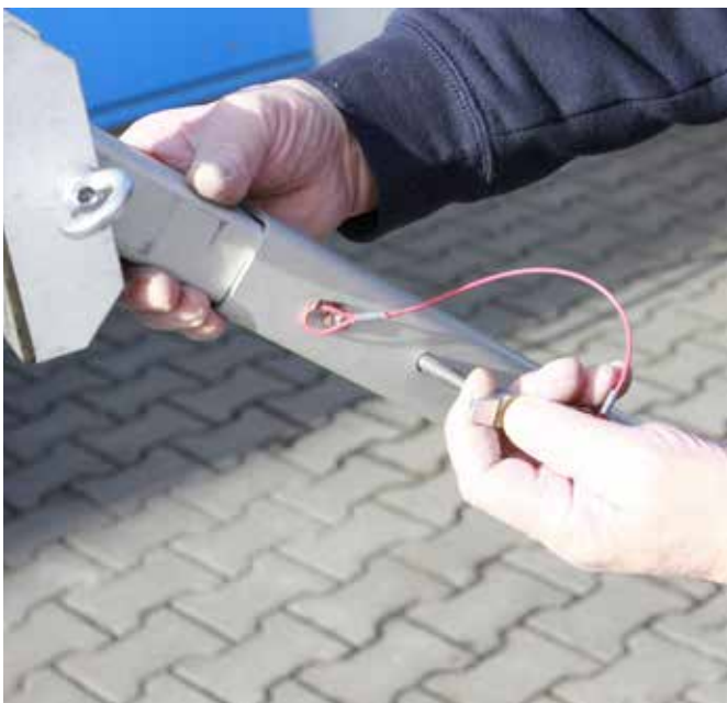
Abb. 58: Den Sicherungsstift wieder einsetzen.
