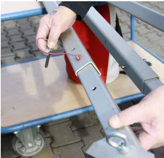
Abb. 7 + 8: Und das Ganze auch beim 3. Fuß wiederholen (hier zu sehen: Ausziehen der Fuß-Verlängerung).
