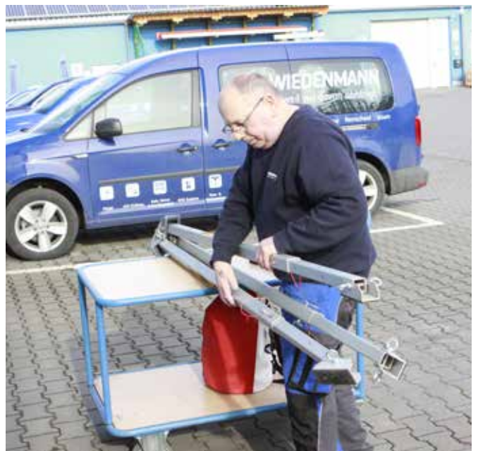
Abb. 10: Kontrollieren, dass alle drei Füße gleich lang sind!
