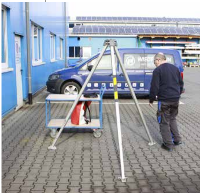
Abb. 13: Kontrollieren, dass alle drei Füße eingerastet sind.
