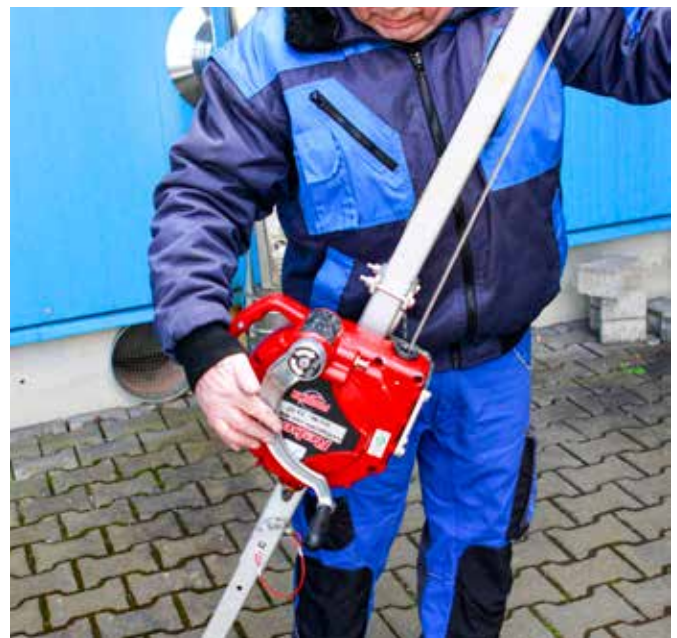
Abb. 47 + 48: Den eingerasteten Sicherungsknopf herausziehen um die Seilwindenfunktion zu aktivieren. Das Gerät ist nun Einsatzbereit.
