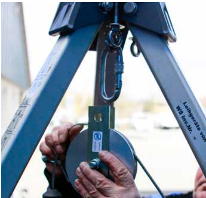
Abb. 35 + 36: Etwas Seil vom HSG abrollen (ca. 1,5 - 2 m) und das Seil um die Seilrolle führen. Dann die Seilrolle mittels...
