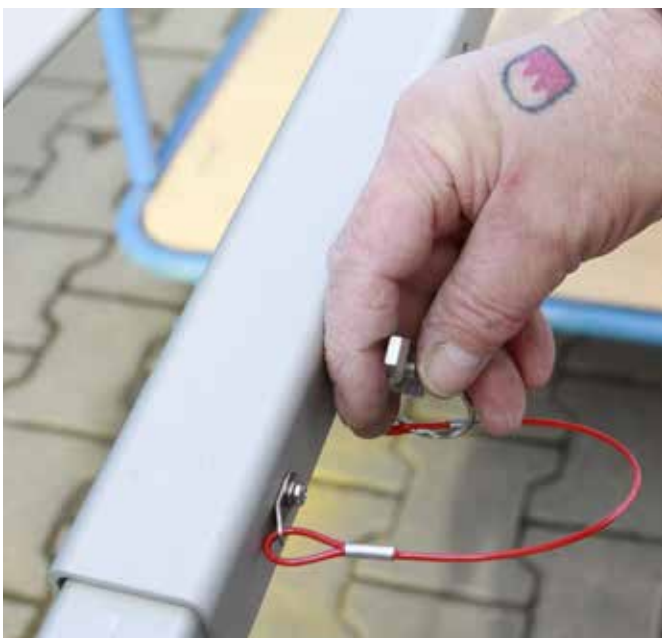
Abb. 60 + 61: Auch beim 2. Fuß den Sicherungsstift entnehmen, Fußverlängerung einfahren und Sicherungsstift wieder einsetzen.
