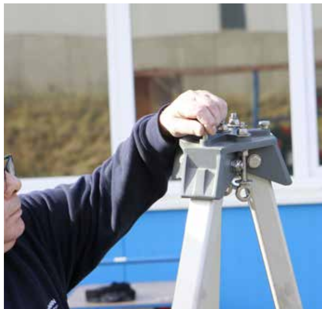
Abb. 68 + 69: ...eingeklappt werden. Bitte darauf achten, dass die Verriegelungsbolzen auch richtig zum Entriegeln herausgezogen werden.
