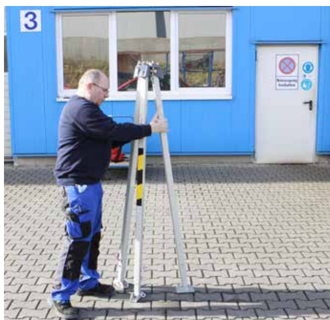
Abb. 70 + 71: Auch dieses Prozedere für jeden einzelnen Fuß wiederholen, bis der Dreibaum...
