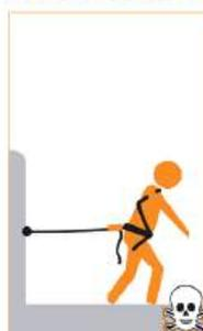
**Horizontaler Einsatz (DACH):** Verwendung in Kombination mit EAP'S oder Horizontalseilsystemen. Das Multifunktionssicherungsgerät BRAKE **blockiert ständig** in Richtung des unteren Seilendes. Die eingestellte Länge kann sich **nicht selbstständig verändern**. Deshalb muß der Verstellvorgang „bewußt“ durchgeführt werden. Somit ist das System für Rückhaltesysteme geeignet.
