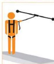
Geeignet als **temporäre Seilsicherung** zum Spannen zwischen **Einzelanschlagpunkten** oder strukturell ausreichend tragfähigen Konstruktionen (min. 10 kN)
