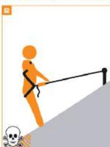
**1 Vertikaler Einsatz:** zur Positionierung (strukturelle Anbindung) an baulichen Konstruktionen (z.B.: Mast/ Leitern)
