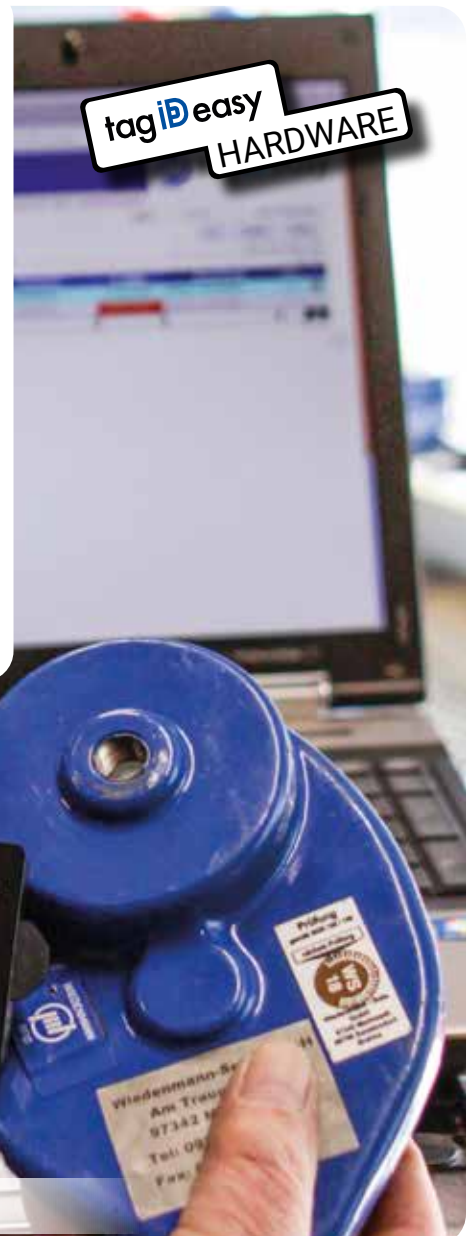
Auslesen eines RFID-Tags mit dem POCKETwork HF-Auslesegerät.
