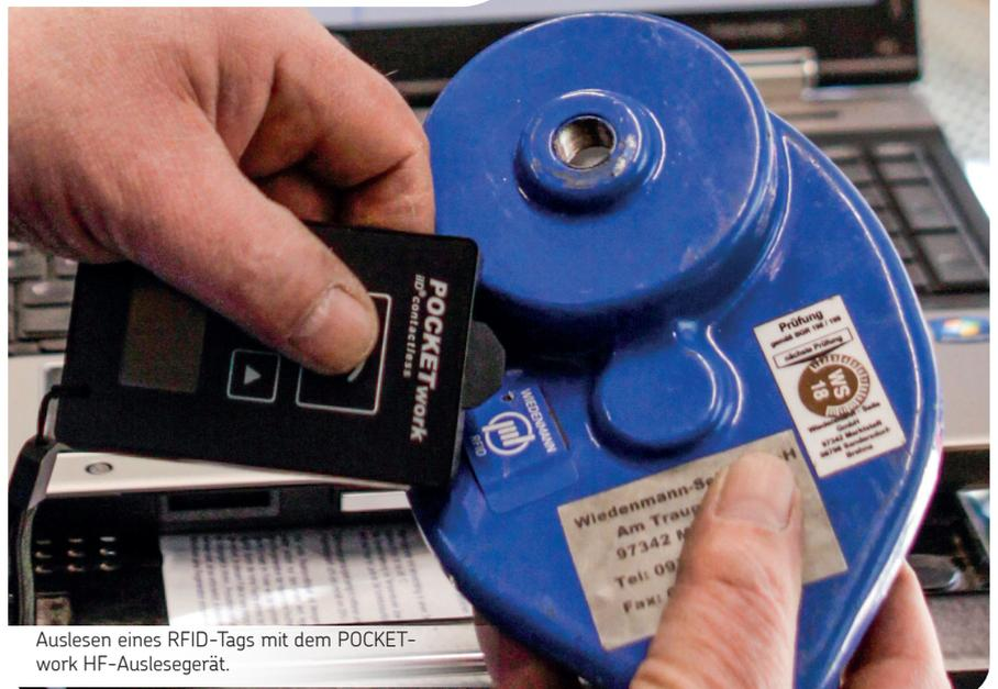
Auslesen eines RFID-Tags mit dem POCKETwork HF-Auslesegerät.
