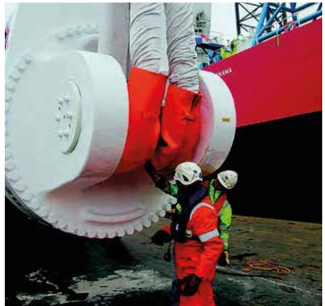
Schwerlastschlinge HMPE mit Kantenschutz
