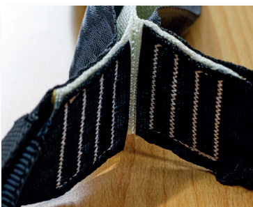
Detail : Bandfalldämpfer (ausgelöst)
