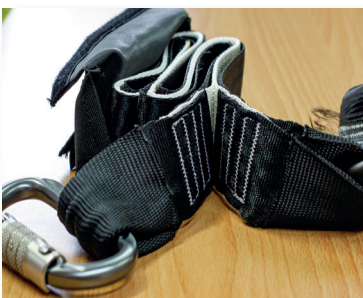
Detail : Bandfalldämpfer (ausgelöst)
