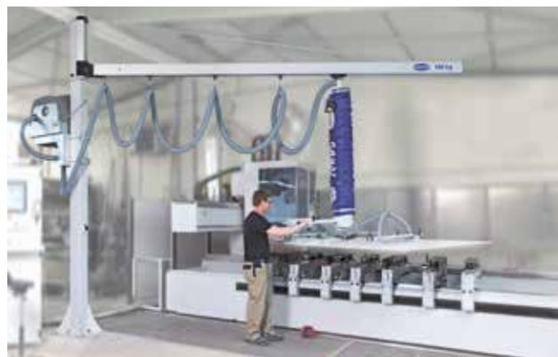
Vakuum-Schlauchheber JumboErgo mit Aluminium-Schwenkkran
