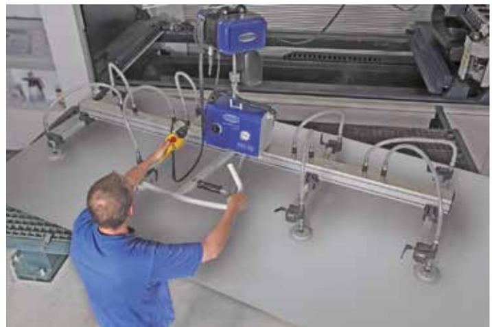
Vakuum-Hebegerät VacuMaster Basic mit Aluminium-Schwenkkran
