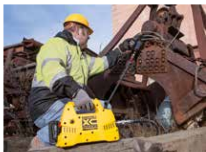
Akkupumpe mit einem Schneidgerät
