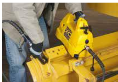
Akkupumpe mit einem Mutternsprenger
