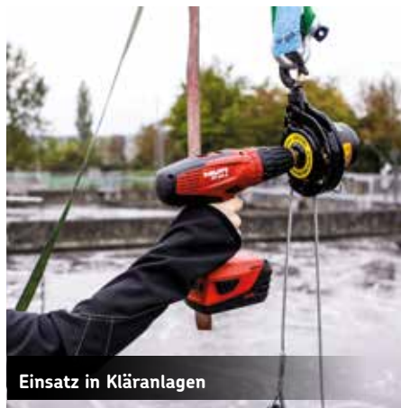
Befestigung am Dreibein durch Adapterplatte mit Anschlagring
