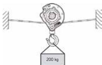
Fixiertes Seil, fahrender PULLEYMAN, Lastrichtung horizontal und schräg
