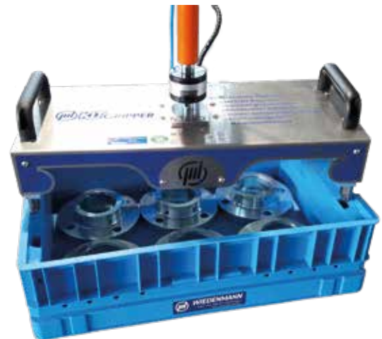
pneumatischer „KLT-Gripper“ mit Sicherheitssensorik
