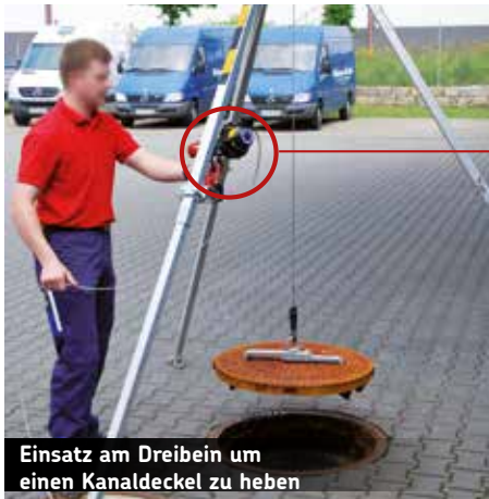
Befestigung am Dreibein durch Adapterplatte mit Anschlagring
