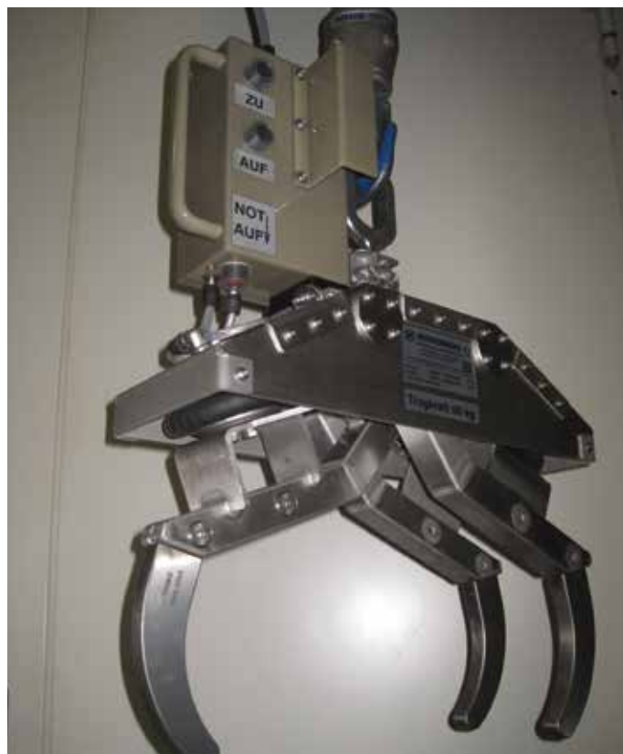
Pneumatischer Niro-Zangengreifer für Polysilicium-Bruchstücke
