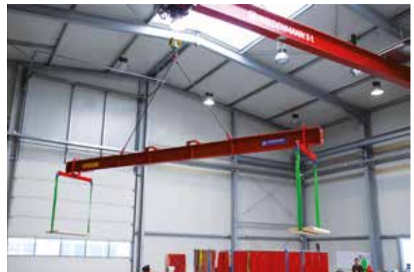
H-Traverse, verstellbar 3.000 kg mit Staplerschuh, Hebebändern und Multiplexplatten
