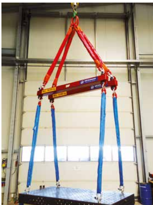
Spreiztraversensystem Gesamttragkraft: 20.000 kg mit Rundschlingengehänge
