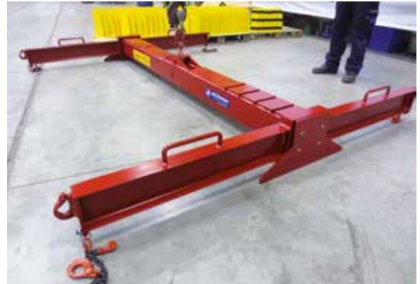
H-Traverse, verstellbar 2.150 kg mit niedriger Bauhöhe
