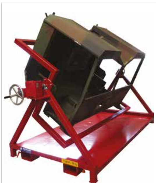
Drehvorrichtung 500 kg für Fahrzeugkabinen Einsatzbereich: Rüstungsindustrie
