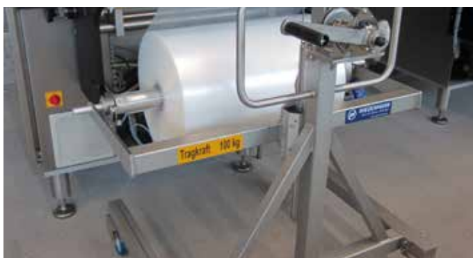
Höhenverstellbarer Folienrollen-Wechselwagen in der Lebensmittelindustrie
