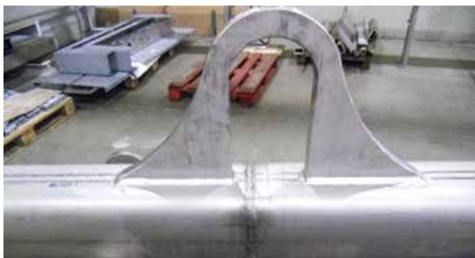
Detailansicht Öse einer Traverse in rostfreier Ausführung
