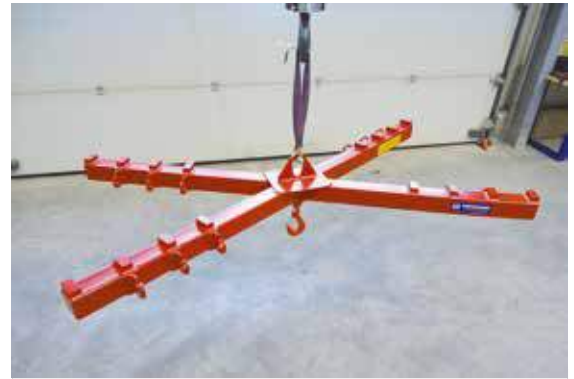
Kreuztraverse 500 kg mit Einlegeraster
