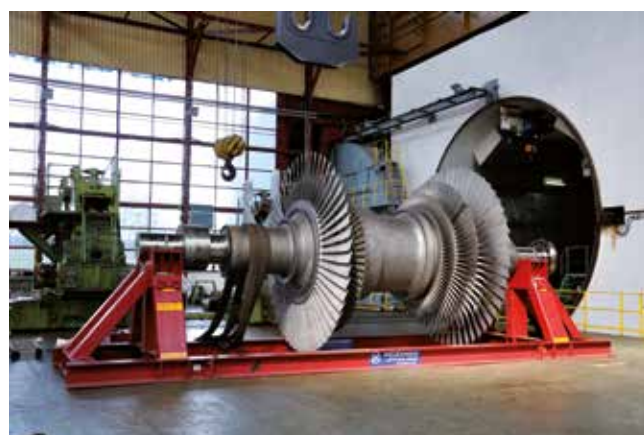
Dampfturbinenläufer 70.000 kg vor dem Einklemmen in das Transportgestell
