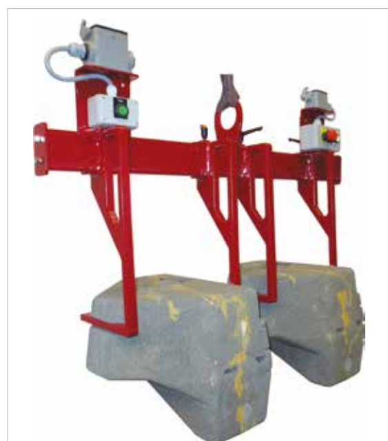
Hebevorrichtung 30 kg zur Aufnahme von zwei Gusskernen inkl. Harting Steckverbinder zur Krananbindung Einsatzbereich: Gießerei
