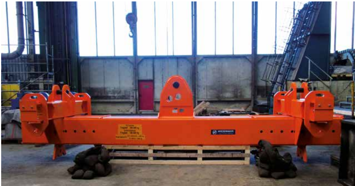
Sonder-H-Traverse für die Reaktorfertigung mit als Balkentraverse einzeln nutzbaren Querträgern Tragfähigkeit: 100.000 kg
