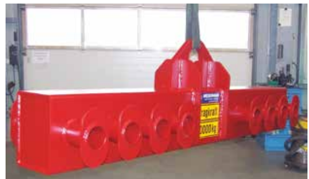
Traverse mit Aufnahmen für Rundschlingen 20.000 kg
