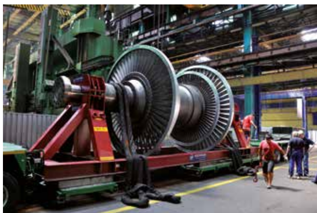
Dampfturbinenläufer beim Abladen vom Transportgestell
