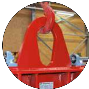
Aufhängeöse für Lasthaken nach DIN 15401
