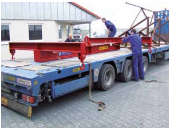
Verladung einer H-Traverse 20.000 kg
