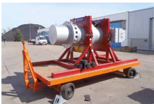
Kesselumwälzpumpe 8.000 kg mit Transportgestell
