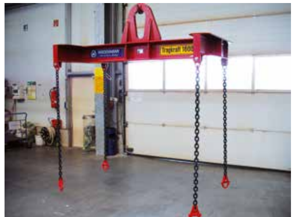
H-Traverse 16.000 kg mit Kettengehänge
