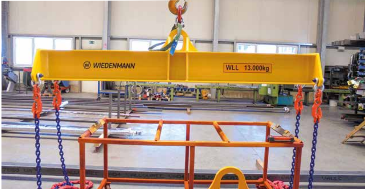
Containertraverse 24Fuß Typ: CTS-130-26 Tragfähigkeit: 13.000 kg Aufnahmebreite: 2.600 mm
