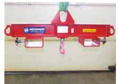
Traverse 1.000 kg mit Anschweißhaken und Staplerschuhen
