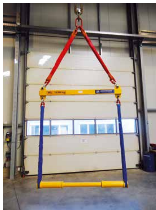
Spreiztraversensystem Gesamttragkraft: 10.000 kg mit Sonder-Transportstange
