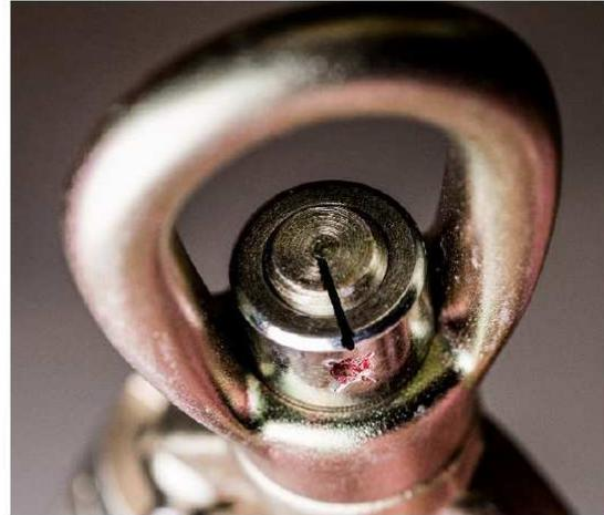
Die Fotos unten zeigen, wie der Spannstift aussieht, bevor er in das Loch passt. Bitte beachten Sie, dass der Stift unter Spannung montiert wird, so dass die Lücke kleiner erscheint.
