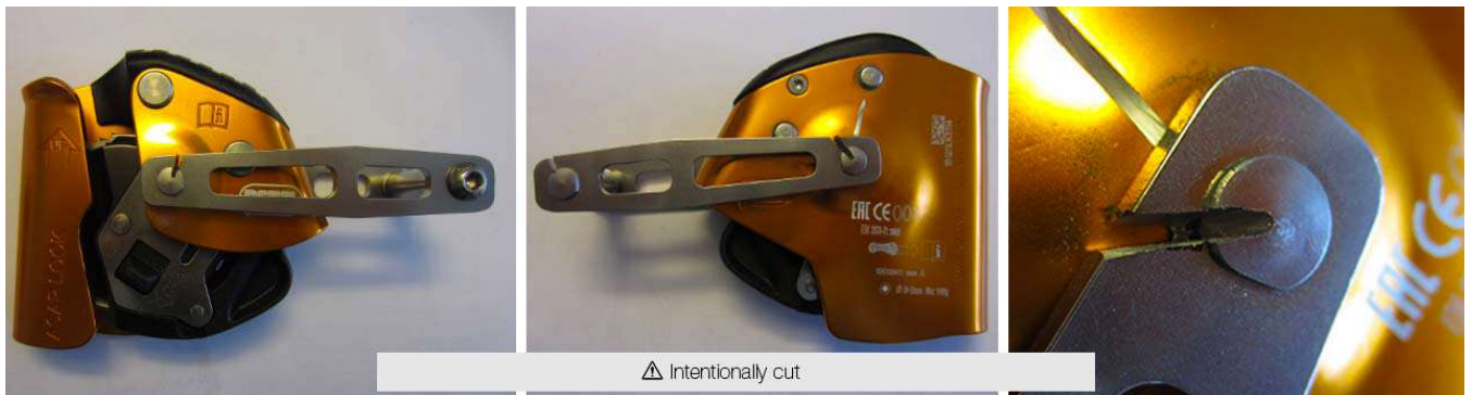
Ein absichtlich beschädigtes ASAP LOCK (vor dem Test)
